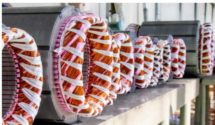
استاتور مورد استفاده در الکتروموتورهای فشار ضعیف
