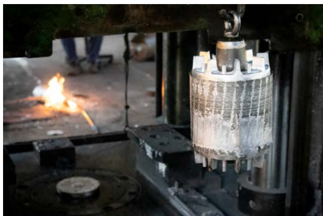
روتور مورد استفاده در الکتروموتورهای فشار ضعیف
