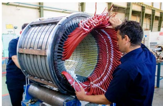
استاتور مورد استفاده در الکتروموتورهای فشار متوسط
