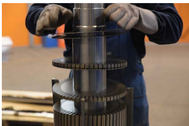
روتور مورد استفاده در الکتروموتورهای فشار ضعیف
