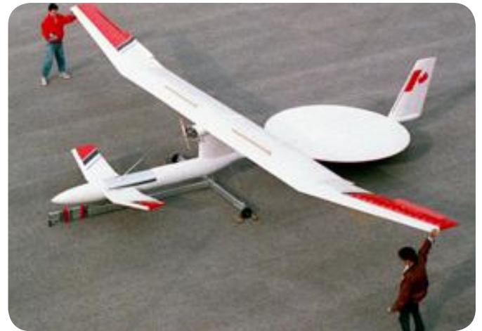
هواپیمای بدون سرنشین سکوی رله ی ساکن با ارتفاع زیاد (SHARP) می تواند انرژی ای را که از زمین مخابره می شود، بگیرد.
