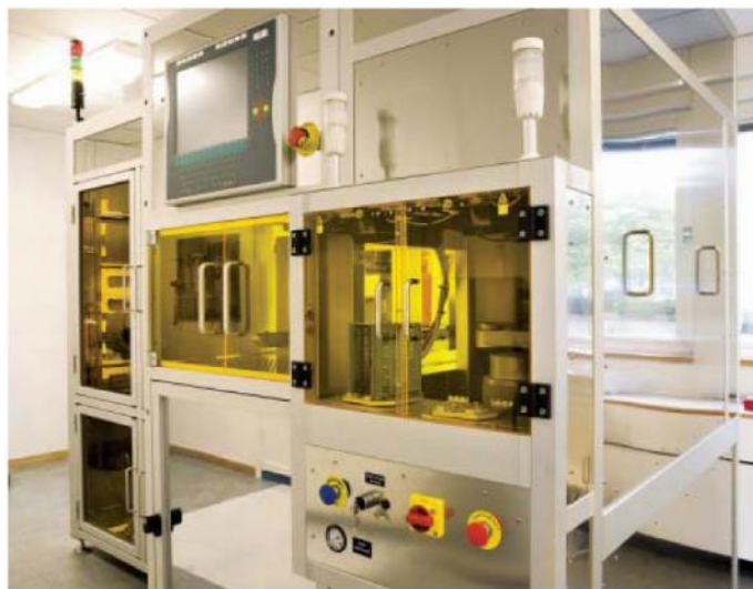
شکل ۲ ابزار تولید لیتوگرافی اثر نانو SINDER با حجم زیاد
