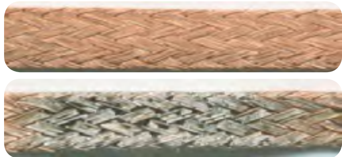
شکل نوار قبل و بعد از جذب قلع
