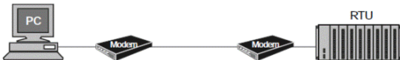
شکل ۱ - ارتباط بین کامپیوتر و RTU بوسیله مودم
