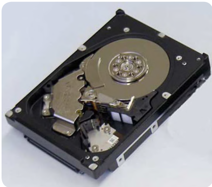
شکل ۳. درایو ۱۵krpm- استفاده شده در آزمایش از آنجایی که فرکانس رزولوشن با سنجش طیف مناسب نمی باشد برای اندازه گیری تابع انتقال از جاروب کردن استفاده می شود. ما تابع انتقال را در رزولوشن ۵Hz درون یابی می کنیم.
