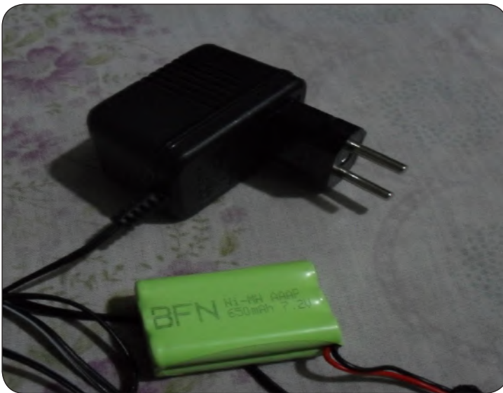
شکل شماره ۱۸: باتری با ولتاژ ۷٫۲ ولت و جریان خروجی ۶۵۰ میلی آمپر شارژر آن
